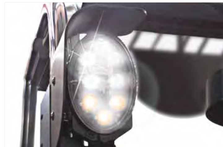
Dankzij de krachtige en zuinige led-werklichten is er beter zicht en kan er ook in het donker op onverlichte plaatsen worden doorgewerkt.
