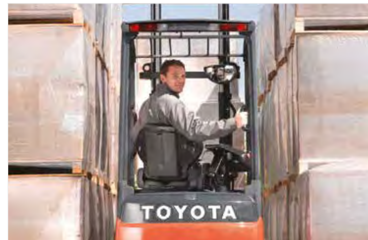
Achteruitrijhandgreep verbetert het comfort bij achteruitrijden en verhoogt de productiviteit door minder belasting van de rug. Optionele draaistoel vereenvoudigt het achteruitrijden en in- en uitstappen
