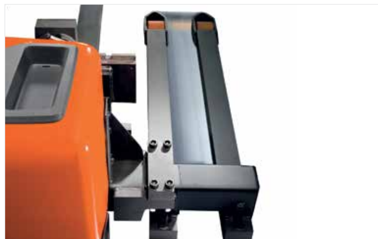
Het HWE100S model kan diverse palletformaten hanteren dankzij de verstelbare breedspoorvorken
