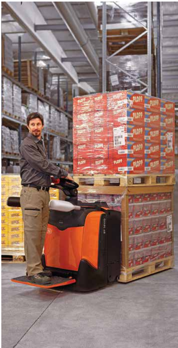
De hoogte van de stuurarm kan met één druk op de knop worden aangepast
