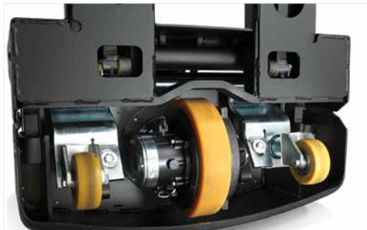
Het unieke Castorlink-systeem beschermt de wielen op ongelijke ondergronden
